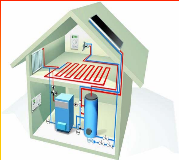
Šema korišćenja sistema za grijanje domaćinstva preko sunčeve energije
