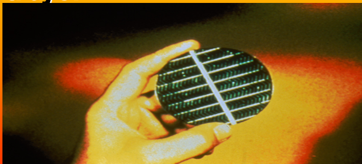
Glavni dio fotonaponskog sistema je solarna ćelija
